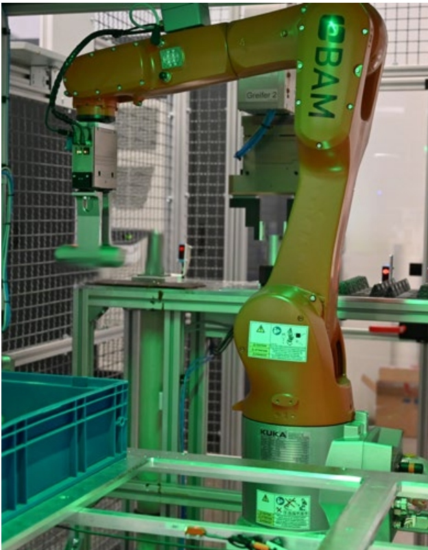
Automatisierungstechnik bei BAM: Mit Hilfe eines 6-Achs-Roboters von KUKA wird das Dreh-/Fräszentrum mit Bauteilen bestückt. Quelle: Shamika Löchel/BAM GmbH
