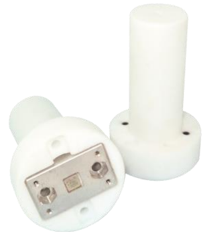
Abb. 3: SASAW-Temperatursensor. Der Messbereich des Sensors umfasst -40\text{ }^{\circ}\text{C} bis 165\text{ }^{\circ}\text{C} bei einer Genauigkeit von \pm 2\text{ }^{\circ}\text{C} . (Bild: SENSEOR)
