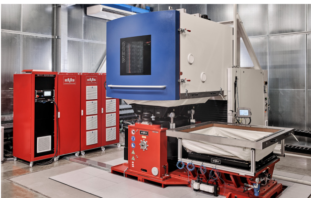
Klimaschrank und Shaker-Vibrationstests zur Simulation von Erschütterungen und Temperaturschwankungen. (Quelle: WEBER)
