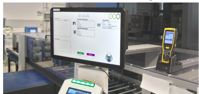
Vernetzte Produktionsanlage mit direkter Anbindung an das ERP und automatischer, artikelbezogener Konfiguration der Anlage. (Quelle: OCQ-Soft)
