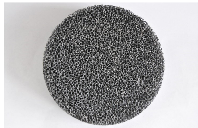
Der keramische Strömungsgleichrichter. Quelle: HAW Landshut
